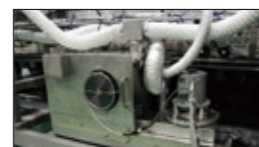
交叉喷嘴加热器 Cutting-edge cross-nozzle heater 冷却风机 Cooling fan 加热部助焊剂回收机构 Heated zone flux management system
