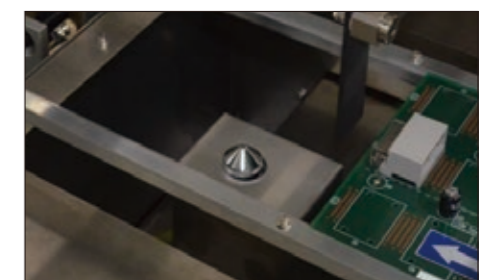
在没有模板的情况下向目标区域涂敷助焊剂 Flux to target location can be applied
