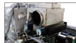
交叉喷嘴加热器 Cutting-edge cross-nozzle heater 冷却风机 Cooling fan 加热部助焊剂回收机构 Heated zone flux management system
