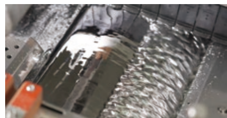
ドロス付着を抑制しはんだ付け性に優れる「RKノズル」
