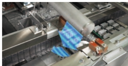
確実にはんだを凝固させる「エアカーテン急冷システム」
